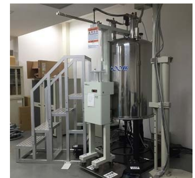
共用機器の一例 核磁気共鳴装置(NMR, ECA-600)
